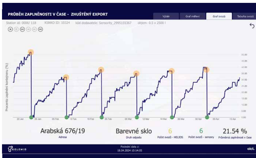
Dashboard s grafem zaplněnosti odpadové nádoby na barevné sklo
