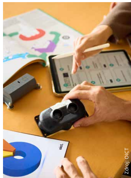
Černý senzor je ultrazvukový, šedý je infračervený
