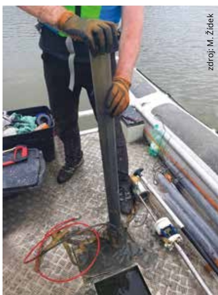
Obrázek 1: Odběr vzorku ze dna nádrže pomocí plovoucí vrtné platformy
