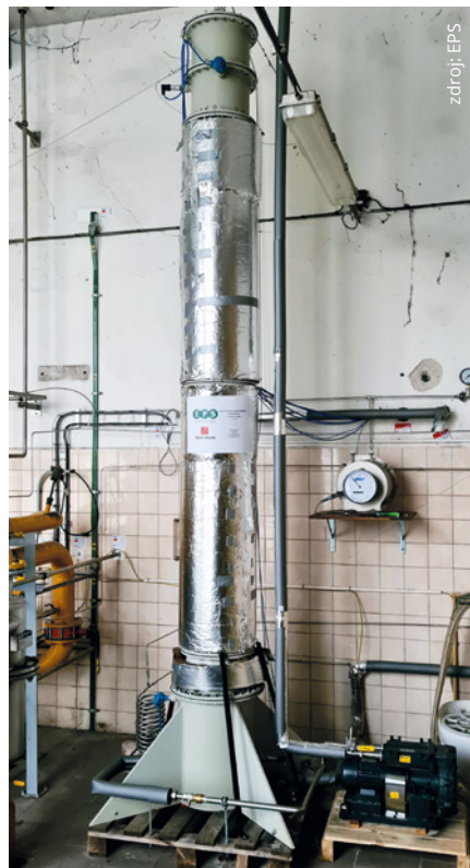
Poloprovozní bioreaktor pro biokonverzi oxidu uhličitého na metan ex situ
