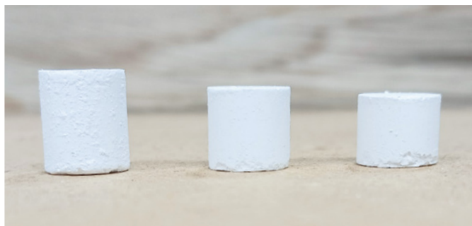
Obrázek 1: Vyobrazení vyrobených pelet ve třech variantách hustoty, zleva nejnižší hustota
